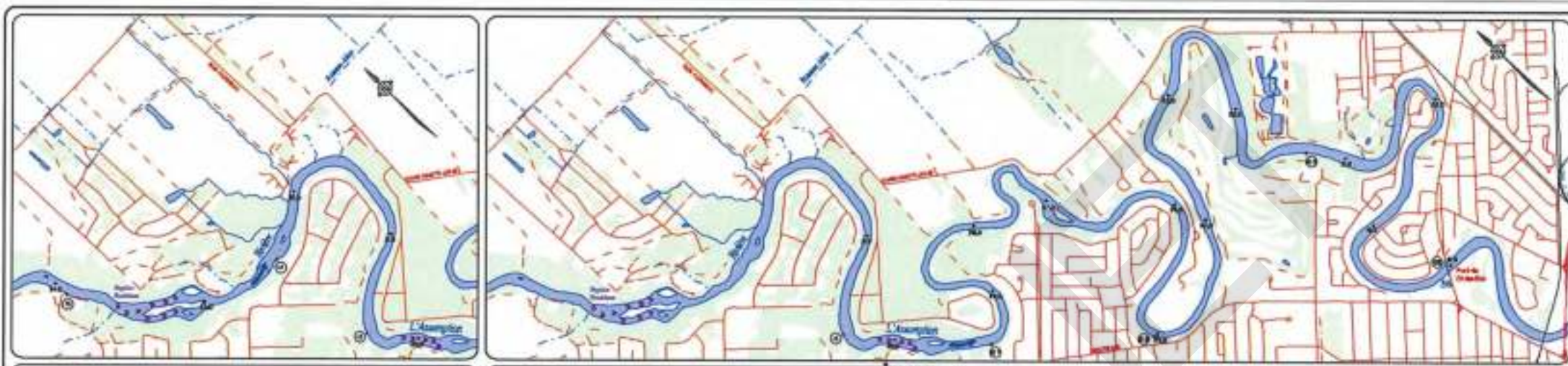
FIGURE 10 VUE EN PLAN DE LA RIVIÈRE L'ASSOMPTION ET LOCALISATION DES SITES D'OBSERVATION DE NIVEAUX D'EAU Secteur amont LEGENDE : Rivière Autre cours d'eau Sens de l'écoulement Routes Sites d'observation de niveau d'eau Stations de mesure Seuil Echelle 1 : 40 000
